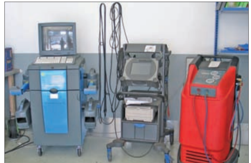
Bereit, um jeden Wagentyp auszumessen. Von links: Lenkgeometrie-Prüfgerät, elektronisches Diagnosegerät und Klimaservice-Gerät.
